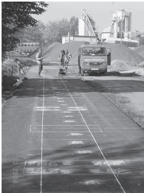
Rys.1. Pas o szerokości 1 m w środkowej części przekroju poprzecznego nawierzchni odcinka próbnego, przeznaczony do pobierania próbek
