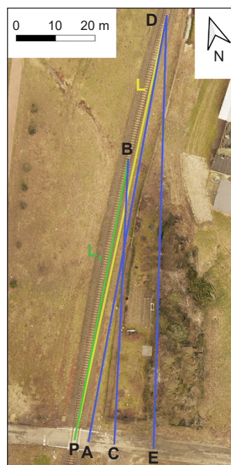
Fig. 6. Orthophotomap with marked visibility triangles (based on Fig. 4 and Table 2) Rys. 6. Ortofotomapa z zaznaczonymi trójkątami widoczności (na podstawie Rys. 4 i Tabl. 2)
