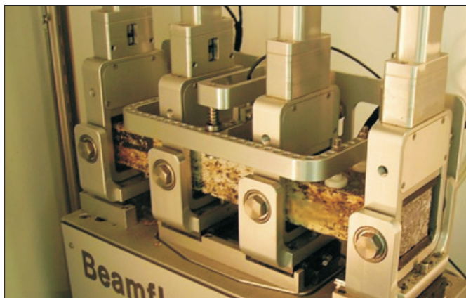
Fig. 3. A 4PB-PR specimen mounted in the test device Rys. 3. Próbkę w urządzeniu do badania 4PB-PR
