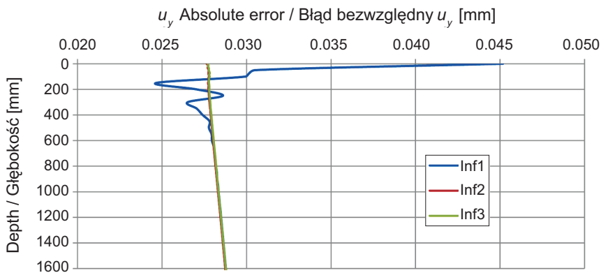
Fig. 17. The absolute error of vertical displacement u_y in infinite element models Rys. 17. Błąd bezwzględny przemieszczenia pionowego u_y w modelach z elementami nieskończonymi
