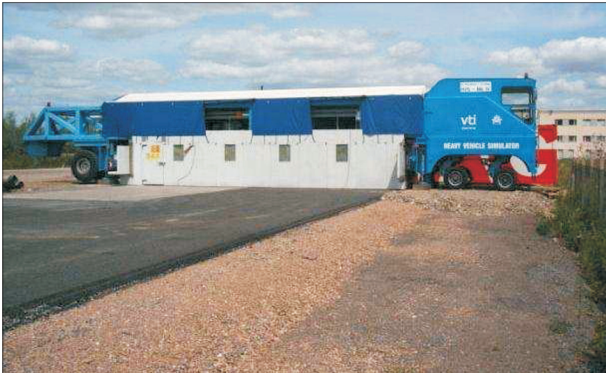
Rys. 21. Symulator HVS w trakcie badań na odcinkach testowych w Pruszkowie
